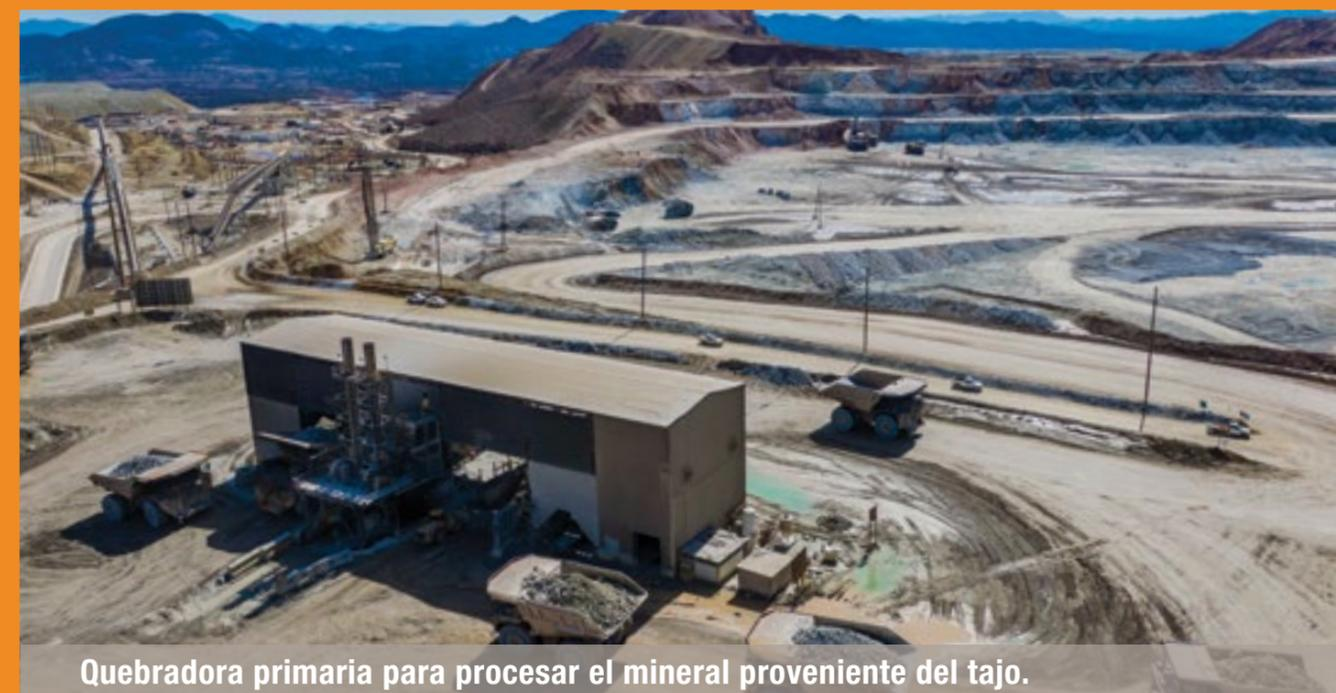
Quebradora primaria para procesar el mineral proveniente del tajo.
