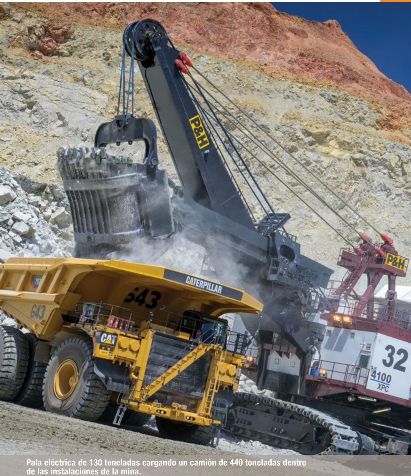
Pala eléctrica de 130 toneladas cargando un camión de 440 toneladas dentro de las instalaciones de la mina.
