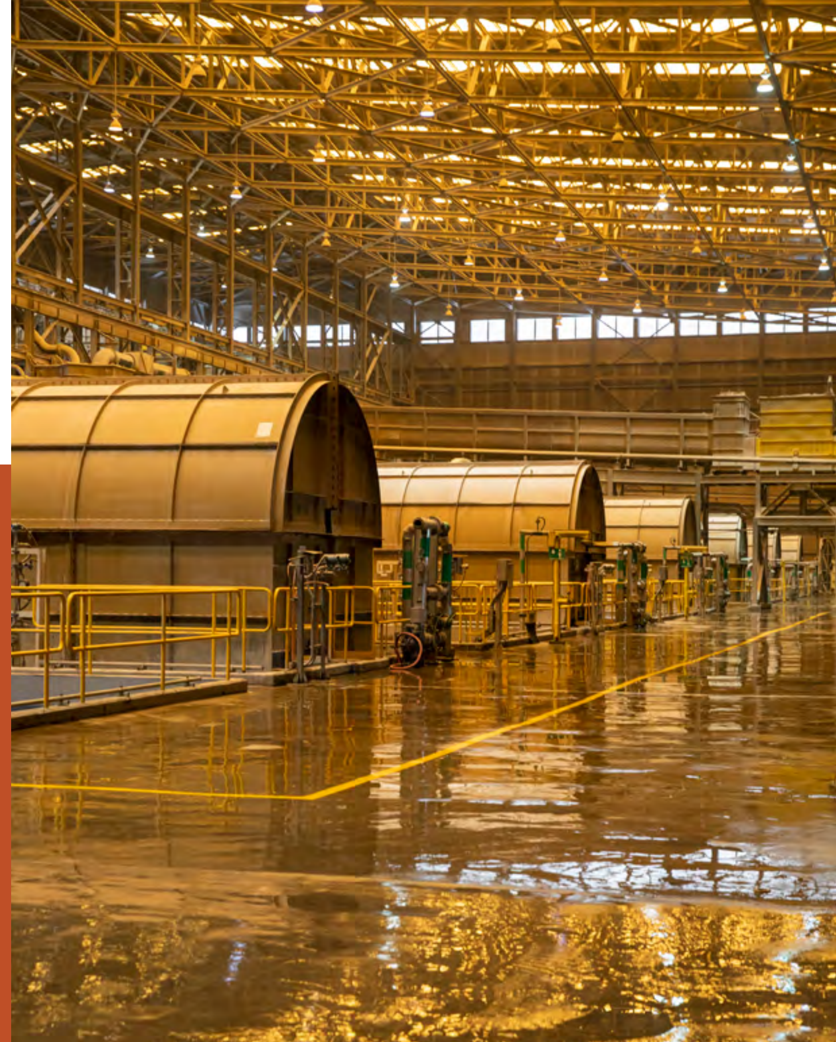
📷 Molinos de bola para el proceso de trituración y molienda del mineral.
