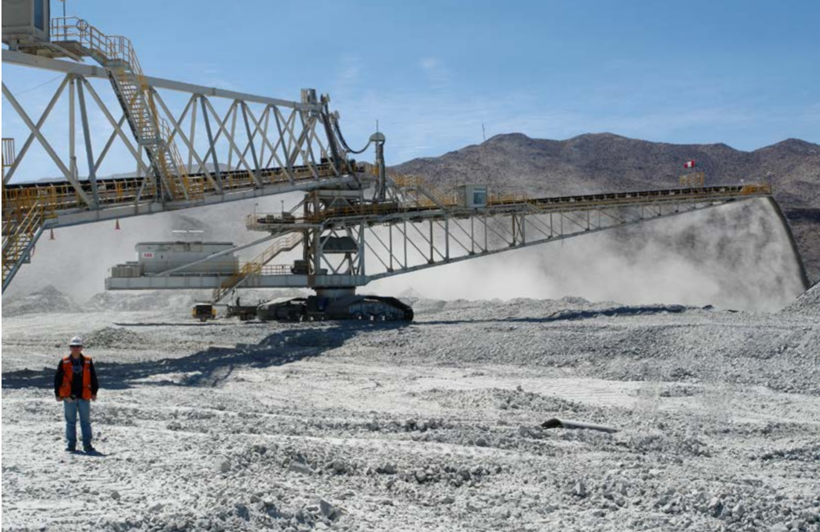
Quebalix en terrero de lixiviación en Toquepala, Tacna, Perú.
